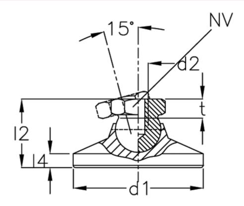
d1 = 40 d2 = 12 l2 = l4 = -NV = 17 Static load (kN) = 30 t min = 11.5
